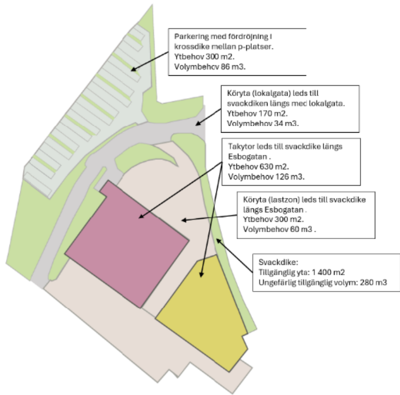
Förslag på fördröjning och rening av dagvatten. Illustration: SWECO Architects, ur dagvattenutredningen (Tyréns,2025).
